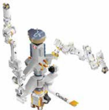
Appelé « la main », le **manipulateur agile spécialisé (SPDM)** est un outil essentiel à l'entretien et à la réparation de la station spatiale. Les deux bras qui le composent lui permettent d'enlever et de replacer de petits éléments sur l'extérieur de la station spatiale lorsque des mouvements précis sont requis.
